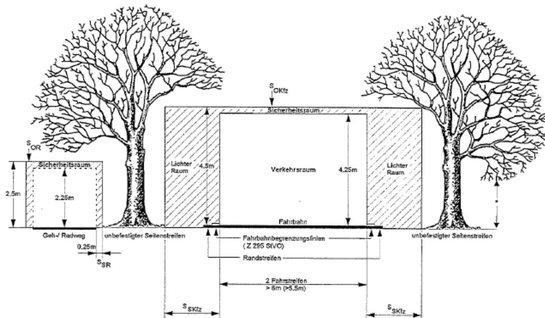
$S_s$  = seitlicher Sicherheitsraum     $S_o$  = oberer Sicherheitsraum    R = Radfahrer    Kfz = Kraftfahrzeug
